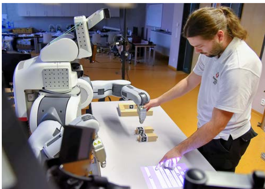
Obrázek č. 1 Systém pro blízkou spolupráci člověka s robotem v úloze přeprogramování robotického pracoviště na nový produkt.
