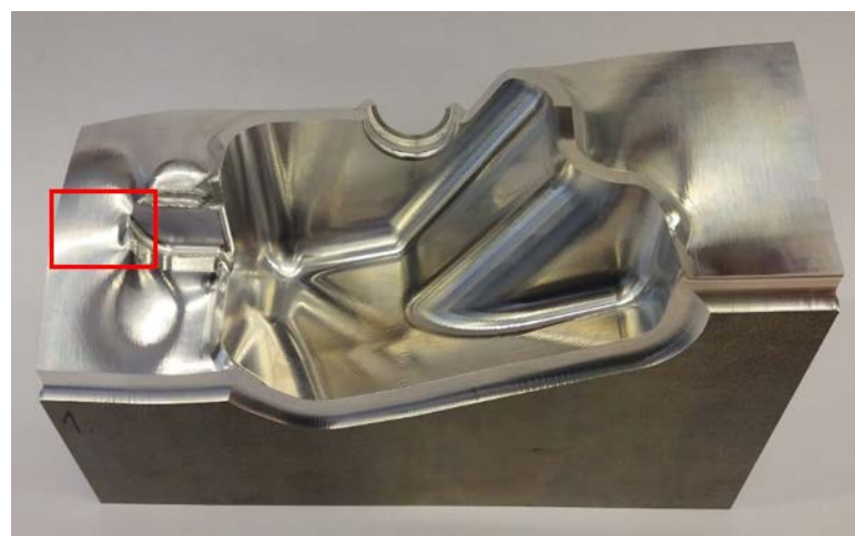
Obr. 1: Forma z Al slitiny. Označen je detail kontroly jakosti povrchu, viz obr. 2.
