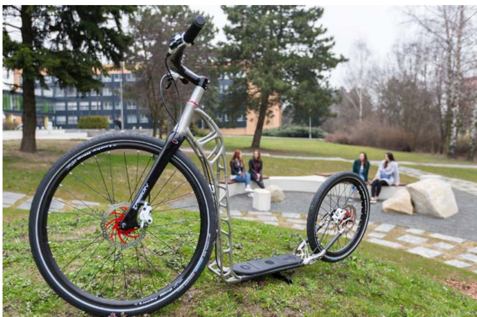
Rám koloběžky z Protolabu na VŠB-TUO byl vytisknut na 3D tiskárně
