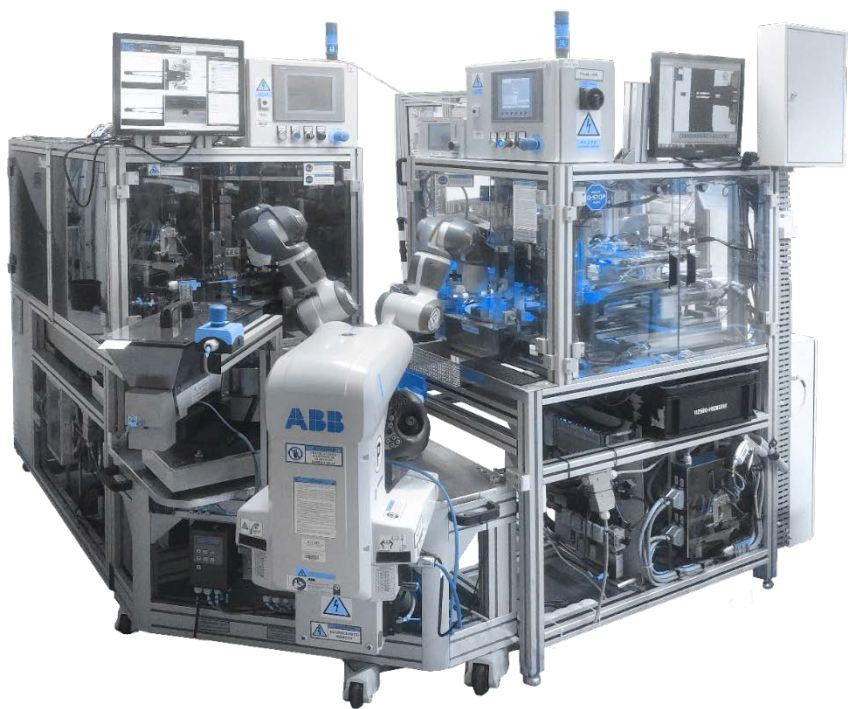
Příklad integrovaného kolaborativního pracoviště z dílny JHV
