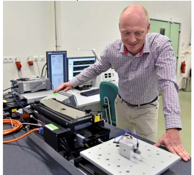
Obrázek 2. Pracoviště pro testování senzorů vibrací.
